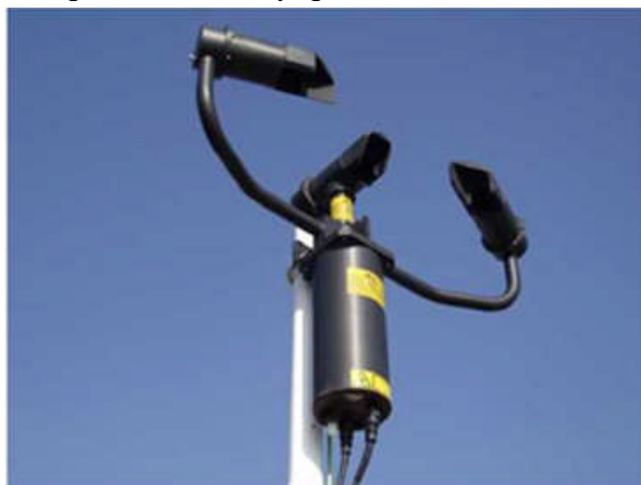
Фигура 16 - Сензор за видимост и за метеорологично състояние (Източник: Biral)
