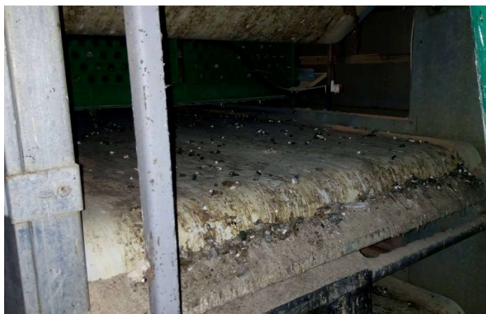
Фиг.3.2-5 Система за събиране и извеждане на тора чрез торови ленти
