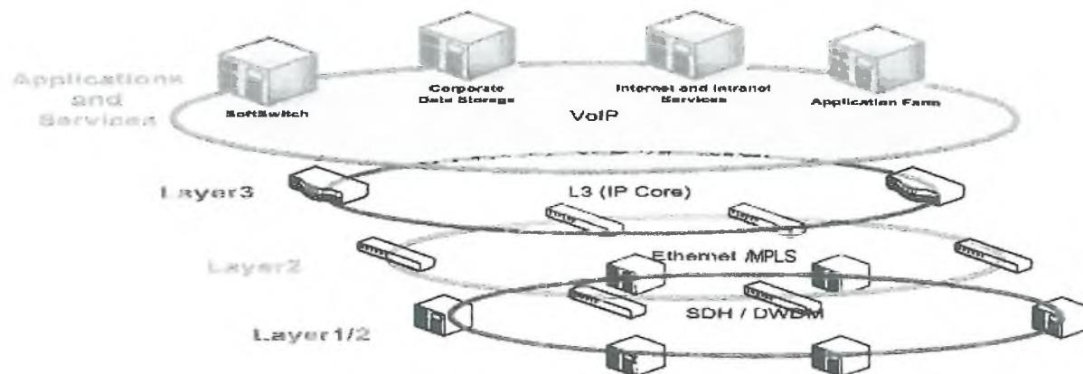
В мрежата на Мобилтел се използват протоколи за динамично рутиране. Гарантирана е висока степен на резервираност на връзките. Преноса на данни и глас на национално ниво се извършва освен през безжичната GSM мрежа и през изградената собствена оптична мрежа FOB /Fiber Optic Backbone/. Оптичният пръстен е изграден на база SDH / DWDM технология и в точките на присъствие е оборудван с Ethernet / MPLS комутатори.
