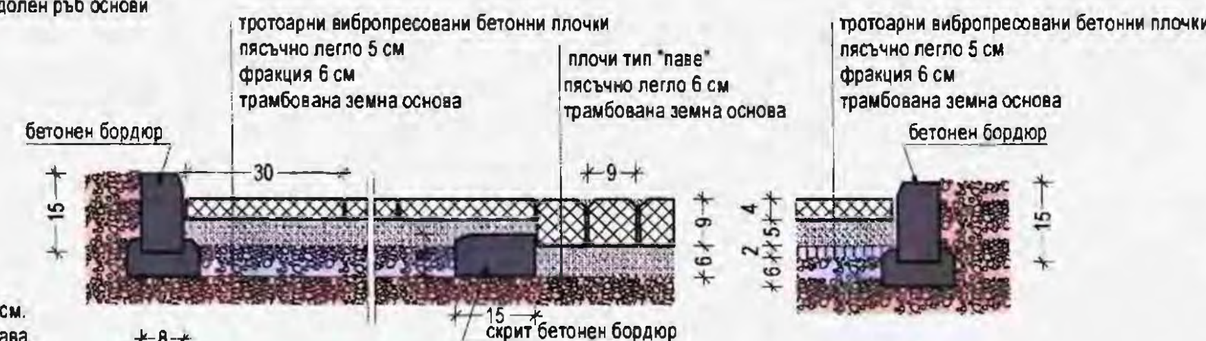
НАСТИЛКА БЕТОННИ ПЛОЧИ И КАМЕННА ТИП "ПАВЕ" М 1:10
