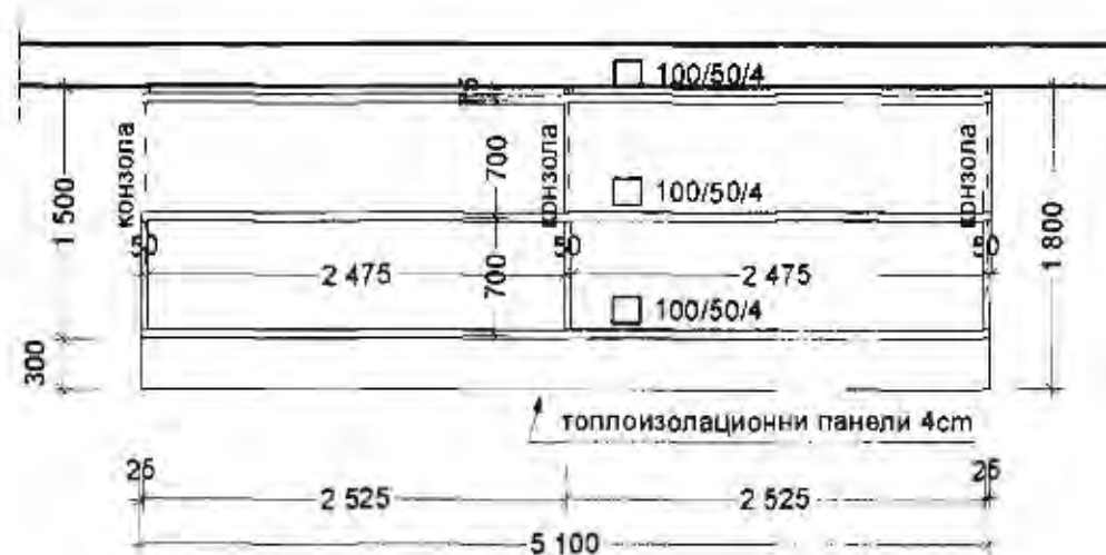
МЕТАЛНА КОНСТРУКЦИЯ СЕННИК НАД СЪЛБА 3 М 1:50
