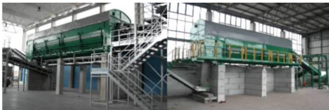
Фигура VI-4 Стационарно барабанно сито
