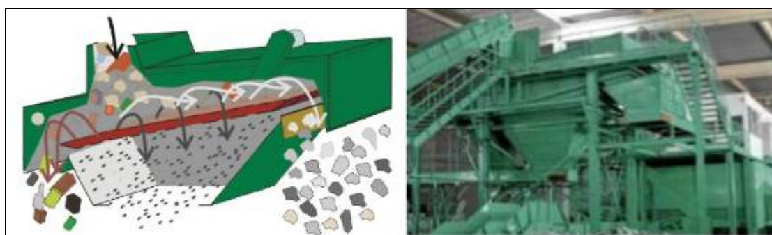
Фигура VI-5 Балистичен сепаратор
