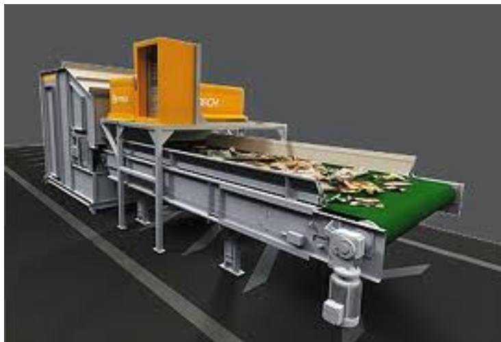
Фигура VI-6 Оптичен сепаратор с инфрачервени лъчи (NIR)
