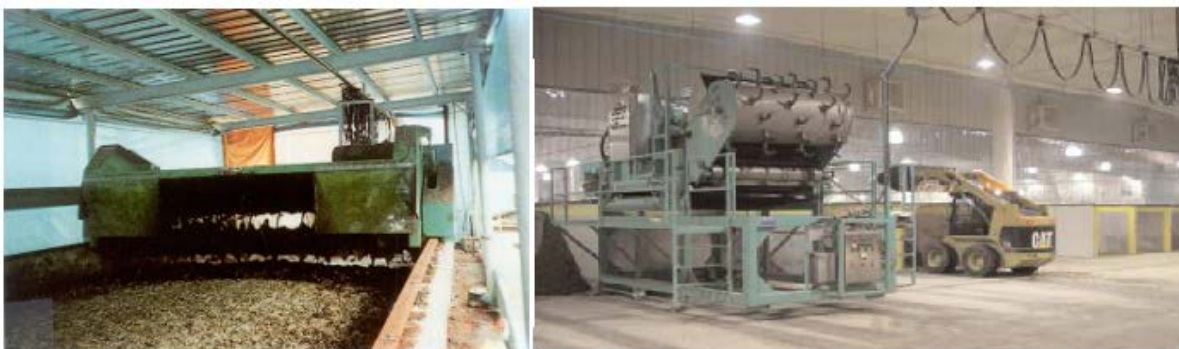
Фигура VI-35 Обръщач тип кран, висящ на стоманено рамо
